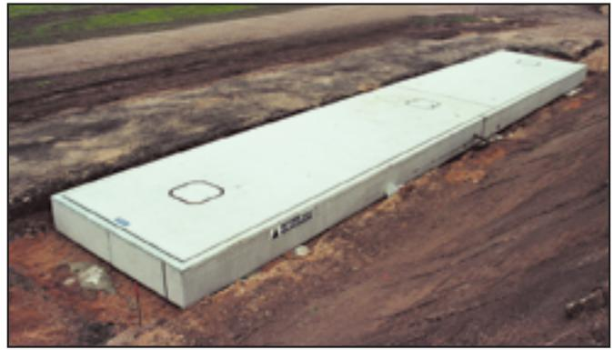
Komplett vormontierte Waage
