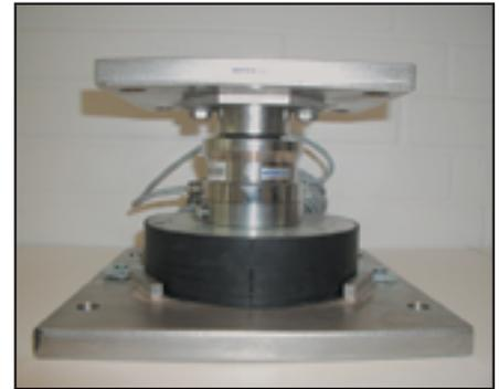
Rostfreie DMS-Wägezelle kompakt mit Spezial-Elastomerlager
